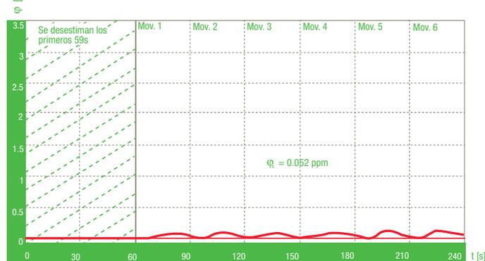
Robustez de la contención en una Vitrina de 1.500 mm. de ancho. Altura de guillotina 500 mm. y velocidad de paso de aire 0,4 m/s
