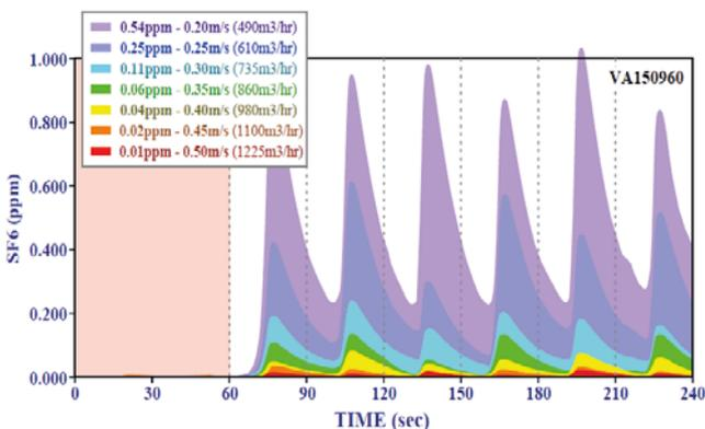
Efecto de la velocidad (Volumen de Extracción según EN 14175-3 robustez y contención de 1,5 metros de ancho de vitrina VAI50960).
